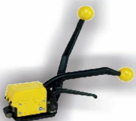
Ручной обвязочный инструмент с широкой областью применения. Прост и эффективен в обслуживании, незаменимый помощник при любых условиях работы, имеет небольшой вес.
