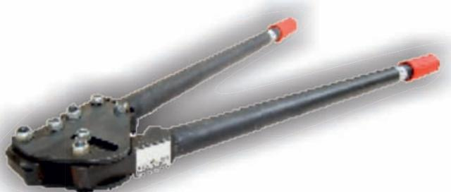
Ручной пломбир для точного скрепления с одинарной засечкой, который гарантирует 65-70% прочности. Он предназначен для совместного использования с инструментом модели НТ-32.
