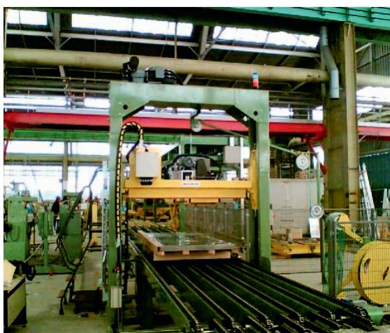
Модель BRS, предназначенная для обвязки листовой упаковки, как по длине, так и по ширине, может быть интегрирована в упаковочные линии и оснащена различными опциями оборудования.
