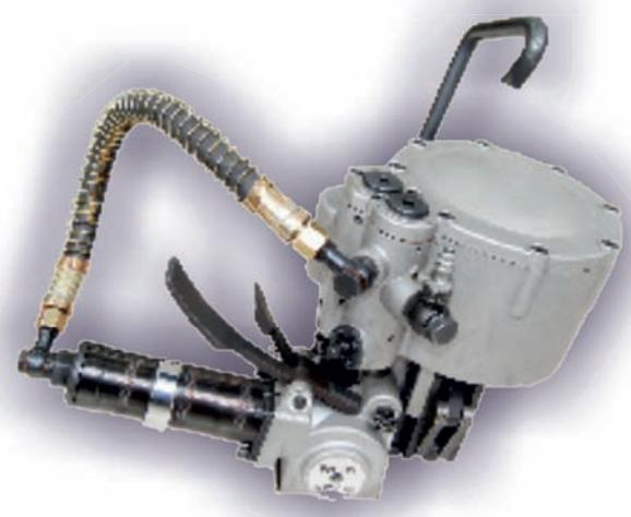
Пневматический комбинированный обвязывающий инструмент для обвязки объектов окружной и нерегулярной формы. Скрепление перекрытыми замками с двойной засечкой гарантирует прочность 80-85%.
